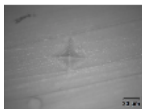
Indentace po vypálení při 760°C po dobu 2 min.* Povrch je vyhlazený a vlasové trhliny jsou zapečetěné.
